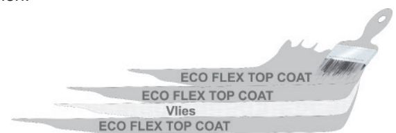
Schichtaufbau ECO FLEX TOP COAT
