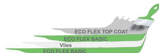
Schichtaufbau ECO FLEX SYSTEM
